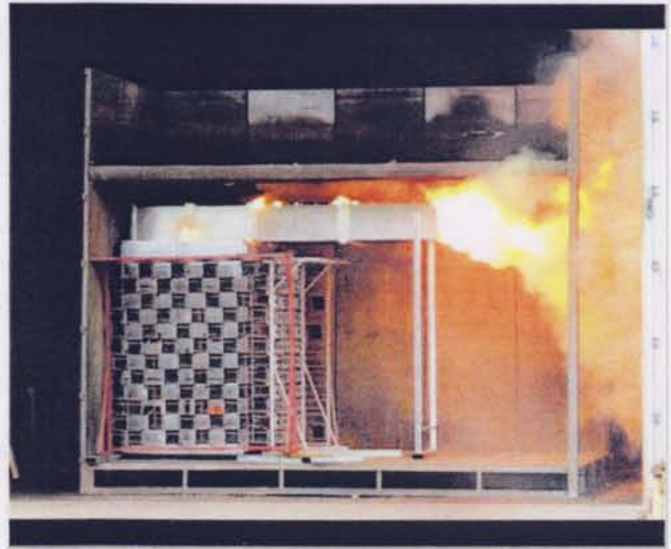
Bild 3. Prüfung der Schaltfelder mit Druckentlastungskanal oben
