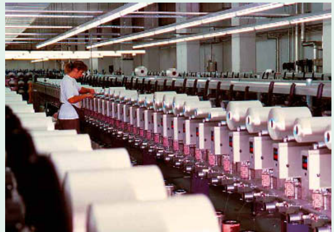
1 Produktion ENKA GmbH im Rayon-Betrieb: Herstellung von Viskose-Fasern
